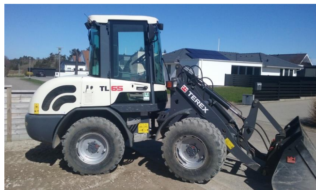
Gummihjuls læsser med skovl og pallegaffler
